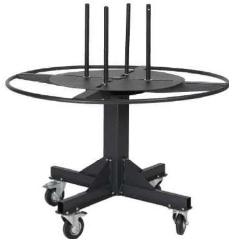
Avec roulettes à frein haute résistance. Poteau central en fer plein Ø40 pour une rigidité maximale. Une rondelle en téflon sous la table permet de freiner la table tournante selon le poids de la couronne plutôt qu'un roulement à bille.
